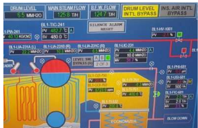
ภาพแสดงการควบคุมโดย Level transmitter C
