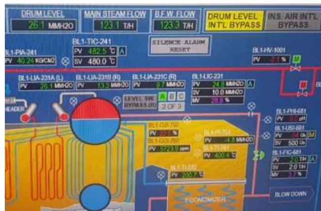
ภาพแสดงการควบคุมโดย Level transmitter A
